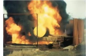
Sowohl CASTOR®- als auch CONSTOR®-Behälter der GNS sind unter diesen Randbedingungen getestet worden. In der Realität lagen die Flammtemperaturen zum Teil deutlich über den festgelegten 800° C.
